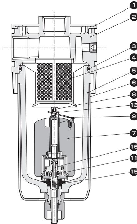
未向滤杯内施加压力时，⑫阀在⑩弹簧的作用下向上提升，通过⑪杆密封圈变为密封状态。其次，向滤杯内施加0.15MPa以上的压力，冷凝水在滤杯内积留时，⑦浮子上升，通过⑨浮动水位臂向上顶起⑧节流孔弹簧。之后，在该⑧节流孔弹簧的作用下，⑨节流孔密封组件类似快动那样打开，将压缩空气引向⑫阀上部腔内，变为加压状态。然后，向下按压⑫阀，离开⑪杆密封圈时，将冷凝水排放到大气中。排放到大气中后，⑦浮子下沉，在⑨浮动水位臂的作用下⑨节流孔密封组件关闭，将⑫阀上部腔内加压的压缩空气通过⑫阀的节流孔排放到大气中。这样，在底部⑩弹簧力的作用下，⑫阀被向上提升，通过⑪杆密封圈实现密封。
