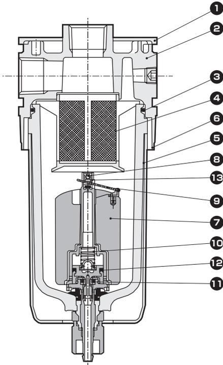
未向滤杯内施加压力时，⑫阀受到⑩弹簧向下的按压，离开⑪杆密封圈。当向滤杯内施加0.1MPa以上的压力时，在⑩弹簧的作用下⑫阀的受压力变大，⑫阀被向上提升，通过⑪杆密封圈实现密封。其次，当冷凝水在滤杯内积留时，⑦浮子上升，通过⑨浮动水位臂向上顶起⑧节流孔弹簧。之后，在该⑧节流孔弹簧的作用下，⑨节流孔密封组件类似快动那样打开，将压缩空气引向⑫阀上部腔内，变为加压状态。然后，向下按压⑫阀，离开⑪杆密封圈时，将冷凝水排放到大气中。排放到大气中后，⑦浮子下沉，在⑨浮动水位臂的作用下⑨节流孔密封组件关闭，将⑫阀上部腔内加压的压缩空气通过⑫阀的节流孔排放到大气中。这样，来自底部的⑫阀受压力大于⑩弹簧的力，⑫阀被向上提升，通过⑪杆密封圈实现密封。
